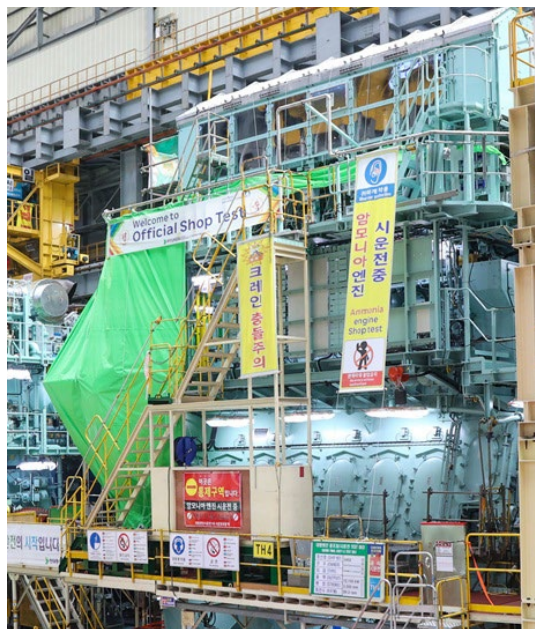
Der Everllence B&W 6G60ME-LGIA HPSCR-Motor, aufgenommen bei Hyundai Heavy Industries Engine & Machinery während des FATs
