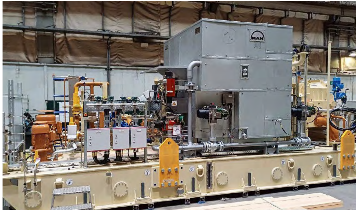
CO 2 -Turbinenskid für Energy Dome
